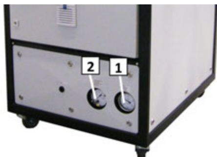
Рис. 17: Манометр и датчик потока
