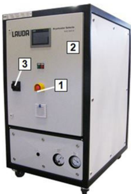
Рис. 1: Расположение выключателя аварийного останова и предохранительного клапана
